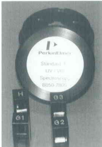
Fig.1. Setul de filtre etalon de factor spectral de transitanție în UV, VIS, NIR.
