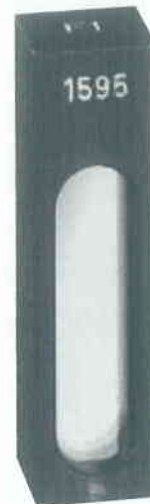
Fig.2. Filtru din sticlă sură, de oxid de Holmium, cu suport.
