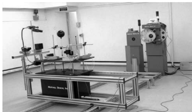
Camerele de ionizare conectate prin cablu la dozimetrele Unidos, plasate pe stand în câmpul de iradiere produs de instalațiile generatoare de radiații.
