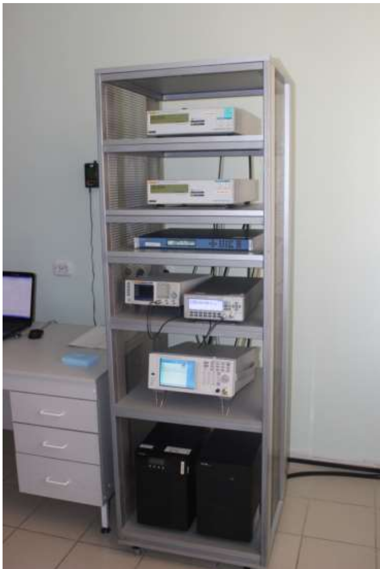
Figura 1. Etalonul unității de timp și frecvență.
