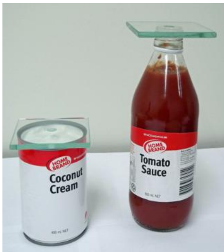
Рисунок 4. Сосуд используемый как пикнометр
