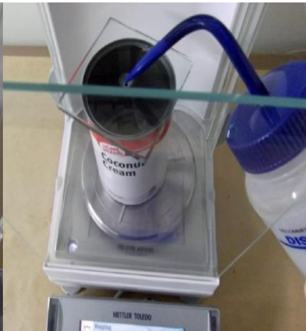
Рисунок 7. Взвешивание пустого сосуда и крышки Рисунок 8. Наполнение водой и взвешивание
