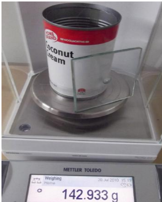
Рисунок 7. Взвешивание пустого сосуда и крышки Рисунок 8. Наполнение водой и взвешивание
