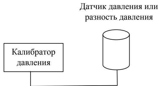
Рисунок 1. Схема установки при проверке датчиков давления
