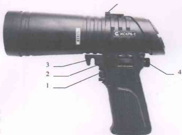
Figura 1. Mijloc de măsurare a vitezei "ISKRA-1"
