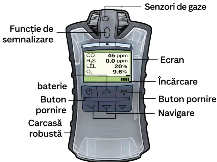
Figura 1. Structura unui analizor de gaze (model)
